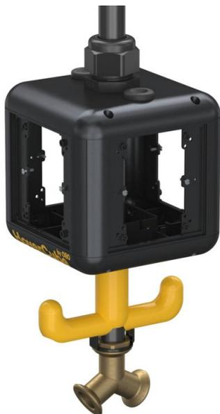
HoverCube non equipaggiato, con 1 m di tubo da 1/2" e raccordo per tubo flessibile dell'aria compressa da 13 x 3,5 mm e ripartitore a 2 vie da 1/2". Con occhio di sospensione e maniglia a gancio. Equipaggiabile sui tutti e 4 i lati. Coperchi di chiusura non inclusi nella fornitura.
