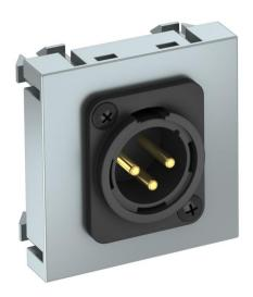
Supporto multimediale con una presa di collegamento XLR, uscita cavo diritta, senza campo di siglatura, connettore XLR tripolare con attacco a vite. Supporto piastra con blocco di fissaggio, adatto per l'installazione orizzontale e verticale nell'ambiente di sistema.
