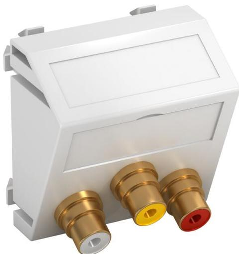
Supporto multimediale con tre prese Cinch di collegamento per l'audio / video, uscita cavo inclinata, con campo di siglatura, tre innesti Cinch (RCA) nella versione presa-presa, codifica dei colori giallo / rosso / bianco. Supporto piastra con blocco di fissaggio, adatto per l'installazione orizzontale e verticale nell'ambiente di sistema.
