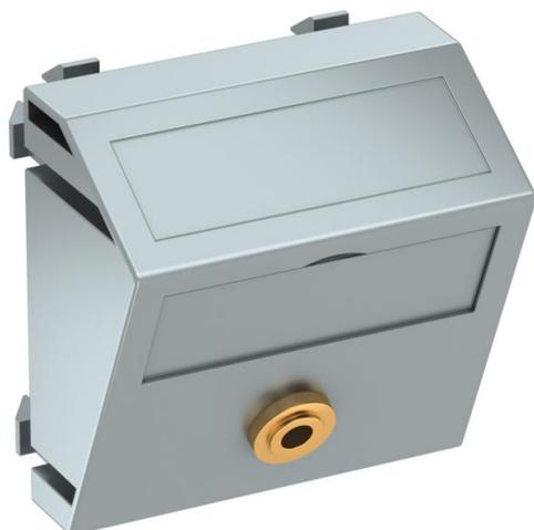
Supporto multimediale con una connessione mini jack, uscita cavo inclinata, con campo di siglatura, presa mini-jack (TRS 3,5 mm) con attacco da saldare. Supporto piastra con blocco di fissaggio, adatto per l'installazione orizzontale e verticale nell'ambiente di sistema.
