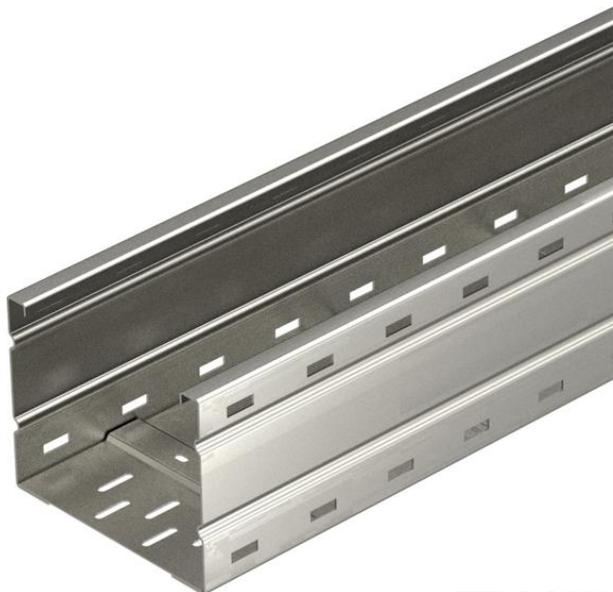
Sistema di passerelle a grande portata, asolata, con altezza dei bordi di 160 mm. I connettori lineari tipo WRVL 110 devono essere ordinati separatamente. Schermatura magnetica senza coperchio 20 dB, con coperchio 50 dB.
