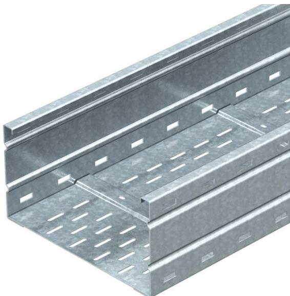
Sistema di passerelle a grande portata, asolata, con altezza dei bordi di 160 mm. I connettori lineari tipo WRV 160 devono essere ordinati separatamente. Schermatura magnetica senza coperchio 20 dB, con coperchio 50 dB.
