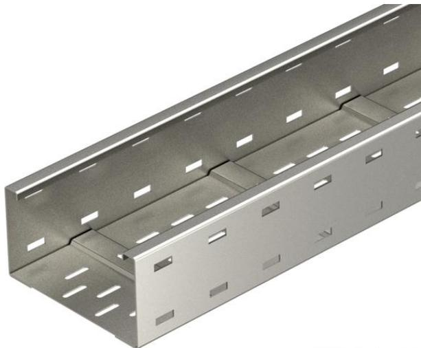
Sistema di passerelle a grande portata, asolata, con altezza dei bordi di 110 mm. I connettori lineari tipo WRVL 110 devono essere ordinati separatamente. Schermatura magnetica senza coperchio 20 dB, con coperchio 50 dB.
