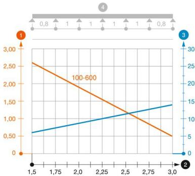
Diagramma di carico passerella portacavi tipo SKSU 60
