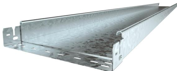
Passerella chiusa con sistema di fissaggio rapido integrato. La lunghezza utile della passerella è di 3.000 mm. L'equipotenzializzazione è garantita senza componenti aggiuntivi.
