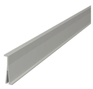
Separatore per la compartimentazione dei canali WDK con altezza canale di 60 mm in caso di diversi livelli di tensione. I separatori vengono inseriti sulle guide presenti sulla base del canale.
