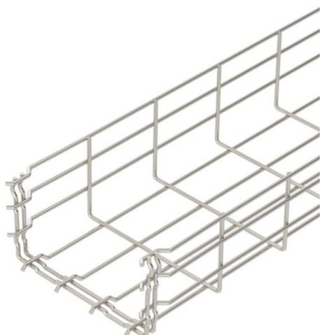
Passerella grigliata ad innesto rapido, con bordo di altezza pari a 105 mm. Per la passerella grigliata non sono necessari ulteriori componenti di collegamento in quanto vengono semplicemente agganciate l'una all'altra. La larghezza di maglia è pari a 50 x 100 mm. Schermatura magnetica senza coperchio 15 dB, con coperchio 25 dB.
