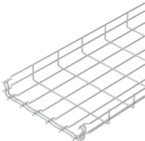
Passerella grigliata ad innesto rapido, con bordo di altezza pari a 55 mm. Per la passerella grigliata non sono necessari ulteriori componenti di collegamento, le due estremità vengono semplicemente inserite una nell'altra. La larghezza della maglia è di 50 x 100 mm (eccezione GRM 55/50 = 20 x 100 mm).
