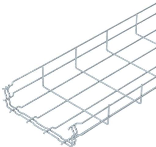
Passerella grigliata ad innesto rapido, con bordo di altezza pari a 55 mm. Per la passerella grigliata non sono necessari ulteriori componenti di collegamento, le due estremità vengono semplicemente inserite l'una nell'altra. La larghezza della maglia è di 50 x 100 mm (eccezione GRM 55/50 = 20 x 100 mm). Schermatura elettromagnetica senza coperchio 15 dB, con coperchio 25 dB.
