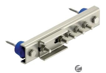
Per la compensazione del potenziale funzionale/di protezione senza scintille secondo DIN VDE 0100-410/-540 e l'equipotenzializzazione di protezione antifulmini senza scintille secondo DIN VDE 0185-305 (IEC 62305) in impianti secondo VDE 0165-1 (IEC/ EN 60079-14)
