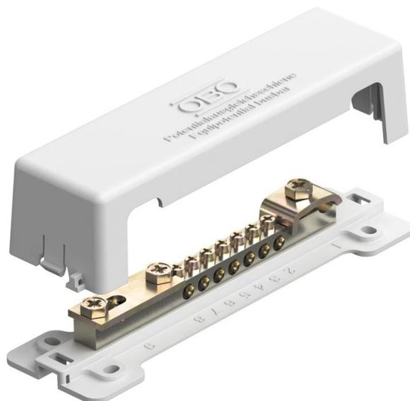
La Barra equipotenziale OBO Green è una soluzione realizzata in acetato di cellulosa CA per l'installazione del sistema di equipotenzializzazione secondo DIN VDE 0100-410/-540 e dell'equipotenzializzazione con parafulmine secondo DIN VDE 0185-305. Il prodotto di base del materiale è un materiale collaudato dell'industria cartacea.
