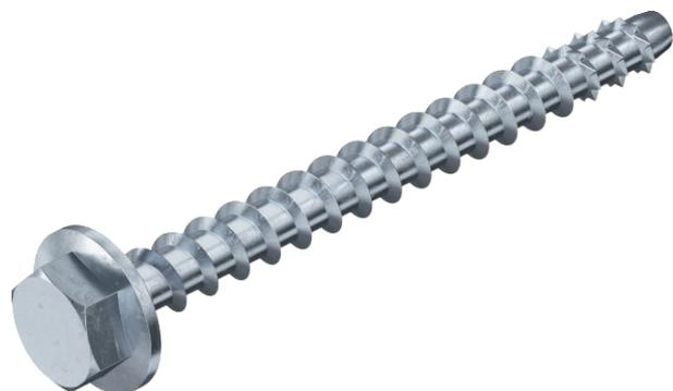
Tirante a vite in acciaio inox per il montaggio diretto senza tassello in calcestruzzo fessurato e non fessurato nonché muratura. Con intaglio esagonale e rondella a pressione per grandi carichi. Idoneo per il fissaggio di profilati di sospensione e mensole a parete in ambienti umidi ed esterni. Prodotto edile a marchio CE, testato EAD, con Valutazione tecnica europea (ETA) e attestazione di utilizzabilità. Portate sotto carico d'incendio fino alla classe di resistenza al fuoco R120 certificate.
