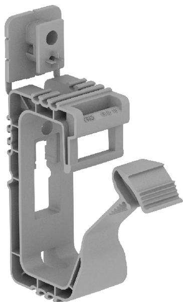
Graffa di supporto multiplo per applicazioni generali, adatta per montaggio a parete e a soffitto. L'elemento di fissaggio inserito può essere serrato mediante sparambulloni o sparamchiodi a gas. Versione grigio pietra, antifiamma secondo DIN VDE 0471/DIN IEC 695 parte 2-1, temperatura di prova 960°C.
