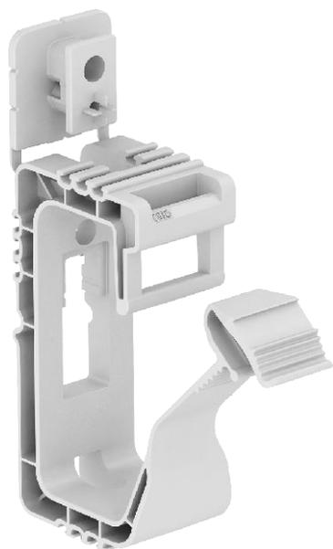
Collare per applicazioni generali con fori di fissaggio di 6 mm Ø, adatto per montaggio a parete e a soffitto. L'elemento di fissaggio inserito può essere serrato mediante sparrulloni o sparrachiodi a gas. La distanza di fissaggio consigliata a pieno carico è di 50-60 cm.
