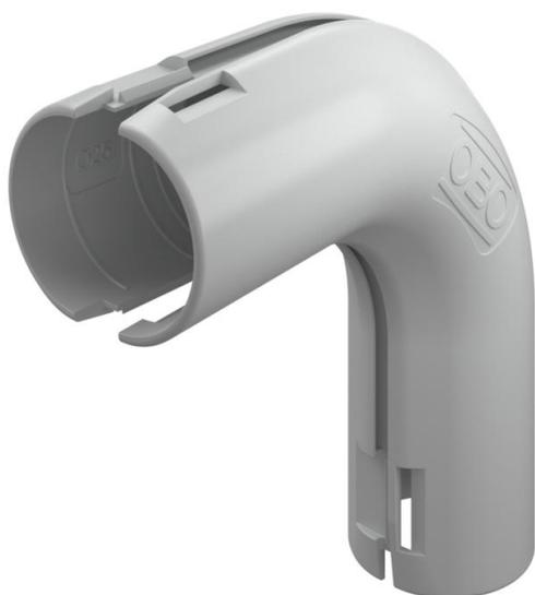
Curva a 90° in materiale plastico, per installazione elettriche. Adatto per tubo Quick o corrugato. Chiusura e apertura senza l'ausilio di utensili. Utilizzabile in un range di temperature da - 25° a + 60° C.
