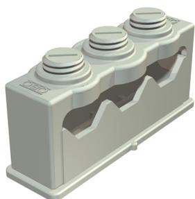
Gaffetta accoppiabile ad innesto ISO, 1 via, per il fissaggio individuale di cavi . Possibilità di fissaggio tramite base adesiva o vite con filettatura M6. Per il fissaggio su strutture in muratura e calcestruzzo utilizzare la colla a presa rapida Impu-Fix tipo 509.
