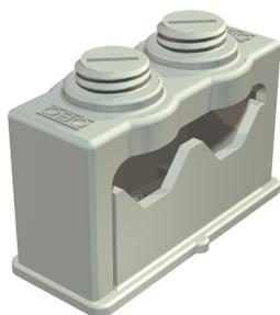
Gaffetta con coperchio a innesto ISO, 2 vie, per il fissaggio individuale di cavi. Possibilità di fissaggio tramite base adesiva o vite con filettatura M6. Per il fissaggio su strutture in muratura e calcestruzzo utilizzare la colla a presa rapida Impu-Fix tipo 509.
