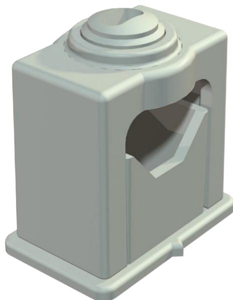
Fissaggio del cavo robusto grazie alla vite di bloccaggio, base adatta all'incollaggio, foro con asola lunga filettata per M6. Per l'incollaggio dei morsetti in polistirolo su strutture in muro e calcestruzzo utilizzare la colla a presa rapida per passerella Impu-Fix tipo 509.
