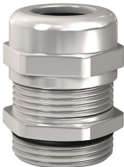
Pressacavo EMC con filettatura metrica secondo IEC 423, per una forte tenuta. Il contatto tra pressacavo e maglia schermante avviene mediante molla di contatto. Scarico di trazione, protezione antitorsione e tenuta sull'intero campo di serraggio. Anello di guarnizione in neoprene. Inserto di fissaggio in poliammide. Con guarnizione toroidale di tenuta premontata sulla filettatura di raccordo, testato VDE secondo DIN EN 50262, grado di protezione IP 68 a 5 bar per 1 ora.
