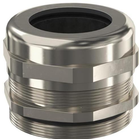
Pressacavo con filettatura di raccordo metrica, dotato di dado cieco, secondo IEC 423. Scarico di trazione, protezione antitorsione e tenuta sull'intero campo di serraggio. Guarnizione in neoprene. Inserto di fissaggio in poliammide.
