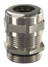
Pressacavo con filettatura di raccordo metrica, dotato di dado cieco, secondo IEC 423. Scarico di trazione, protezione antitorsione e tenuta sull'intero campo di serraggio. Guarnizione in neoprene. Inserto di fissaggio in poliammide.
