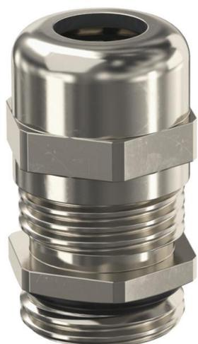
Pressacavo con filettatura di raccordo metrica, dotato di dado cieco, secondo IEC 423. Scarico di trazione, protezione antitorsione e tenuta sull'intero campo di serraggio. Guarnizione in neoprene. Inserto di fissaggio in poliammide.
