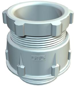
Pressacavo standard, forma A secondo DIN 46320 con guarnizione interna singola inNR/SBR, filettatura metrica secondo IEC 423.
