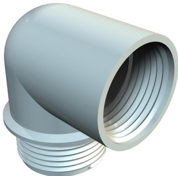
Manicotto angolare con filettatura interna ed esterna PG secondo DIN 40430. Il manicotto può essere trasformato in un pressacavo angolare con 2 guarnizioni di pressione 107/D in acciaio, una guarnizione di tenuta 107/A o 107/B e una vite a pressione 107/E.
