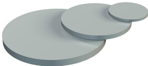
I dischi di tenuta offrono non solo protezione meccanica ma mantengono anche il grado di protezione dei pressacavi in plastica e metallo secondo DIN 46320 prima dell'installazione del cavo. Utilizzo: i dischi vengono inseriti tra la vite a pressione e l'anello di spinta. Per garantire il rispetto del grado di protezione IP 65 si consiglia di posizionare i dischi tra l'anello di spinta e l'anello di tenuta. Per il montaggio del cavo i dischi vengono rimossi e possono essere riutilizzati.
