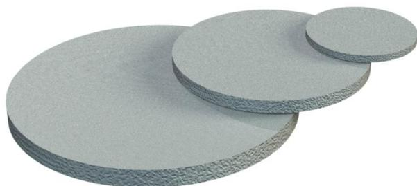
Piastra di protezione, in polietilene cellulare, per la chiusura ermetica antipolvere dei pressacavi V-TEC e V-TEC MS prima dell'installazione del cavo. Utilizzo: le piastrine vengono preinstallate tra il dado esagonale cieco e la guarnizione. Per l'inserimento del cavo non è necessaria la rimozione ma è sufficiente far penetrare il cavo all'interno. Nota: le piastre non offrono alcuna protezione meccanica.
