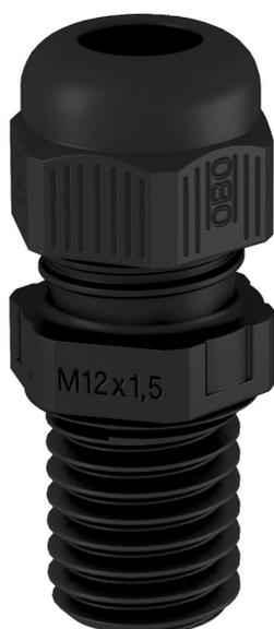
Pressacavo con filettatura metrica, adatto per scatole di derivazione, per applicazioni residenziali ed industriali. Con scarico della trazione e guarnizione di tenuta integrata, testato secondo norma CEI EN 62444. Grado di protezione IP68. Range temperatura -20°C a +65°C.
