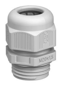
Pressacavo con filettatura metrica, adatto per scatole di derivazione, per applicazioni residenziali ed industriali. Con scarico della trazione e guarnizione di tenuta integrata, testato secondo norma CEI EN 62444. Grado di protezione IP68. Range temperatura -20°C a +65°C.
