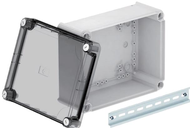
Scatola di derivazione chiusa per il collegamento di cavi e linee in ambienti interni ed ambienti esterni protetti. Forma rettangolare senza ingressi. Adatta per il montaggio su pareti e soffitti, il montaggio su lamiere di montaggio e filettatura nel pavimento. Con la possibilità di fissaggio interno e il montaggio su sezioni angolari. Coperchio alto con chiusura rapida, piombabile. Costruito con materiali privi di alogen. Incluso profilo di sospensione.
