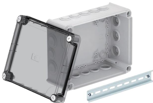
Scatola di derivazione per il collegamento di cavi e linee in ambienti interni ed ambienti esterni protetti. Forma rettangolare con tenute ad innesto sui lati e inserti di deviazione nel pavimento. Adatta per il montaggio su pareti e soffitti, il montaggio su lamiera di montaggio e filettatura nel pavimento. Con la possibilità di fissaggio interno e il montaggio su sezioni angolari. Coperchio alto con chiusura rapida, piombabile. Costruito con materiali privi di alogeni.
