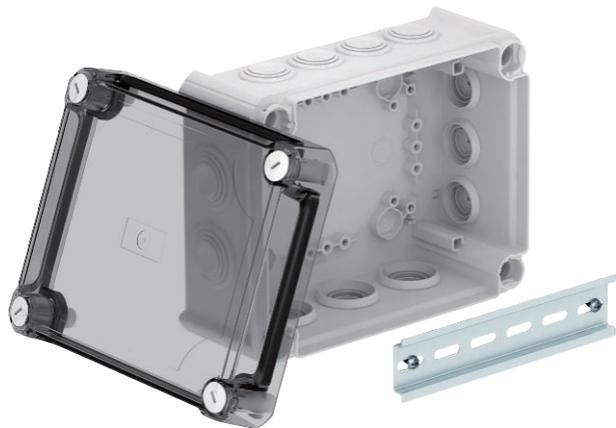
Scatola di derivazione per il collegamento di cavi e linee in ambienti interni ed ambienti esterni protetti. Forma rettangolare con tenute ad innesto sui lati e inserti di deviazione nel pavimento. Adatta per il montaggio su pareti e soffitti e il montaggio su lamiere di montaggio. Con la possibilità di fissaggio interno e il montaggio su sezioni angolari. Coperchio alto con chiusura rapida, piombabile. Costruito con materiali privi di alogeni.
