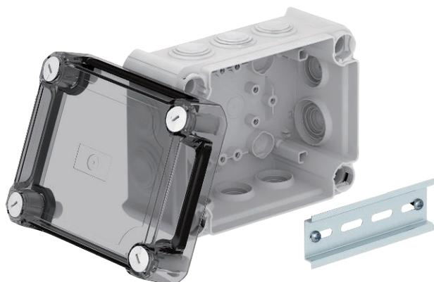
Scatola di derivazione per il collegamento di cavi e linee in ambienti interni ed ambienti esterni protetti. Forma rettangolare con tenute ad innesto sui lati e inserti di deviazione nel pavimento. Adatta per il montaggio su pareti e soffitti e il montaggio su lamiere di montaggio. Con la possibilità di fissaggio interno e il montaggio su sezioni angolari. Coperchio alto con chiusura rapida, piombabile. Costruito con materiali privi di alogeni.
