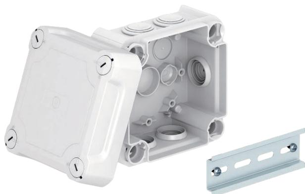
Scatola di derivazione per il collegamento di cavi e linee in ambienti interni ed ambienti esterni protetti. Forma quadrata con tenute ad innesto sui lati e inserti di deviazione nel pavimento. Adatta per il montaggio su pareti e soffitti e il montaggio su lamiere di montaggio. Con la possibilità di fissaggio interno e il montaggio su sezioni angolari. Coperchio alto con chiusura rapida, piombabile. Costruito con materiali privi di alogeni.
