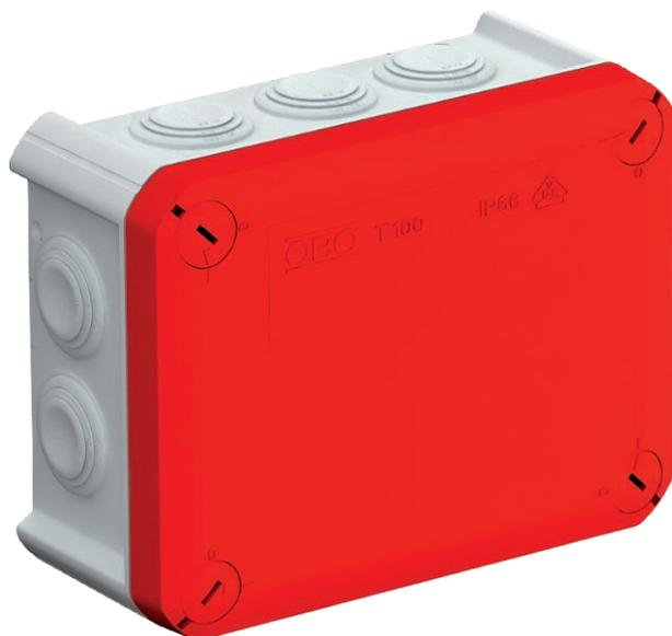
Scatola di derivazione per il collegamento di cavi e linee in ambienti interni ed ambienti esterni protetti. Forma rettangolare con tenute ad innesto sui lati e inserti di deviazione nel pavimento. Adatta per il montaggio su pareti e soffitti e il montaggio su lamiera di montaggio. Con la possibilità di fissaggio interno e il montaggio su sezioni angolari. Coperchio con chiusura rapida, piombabile. Costruito con materiali privi di alogeni.
