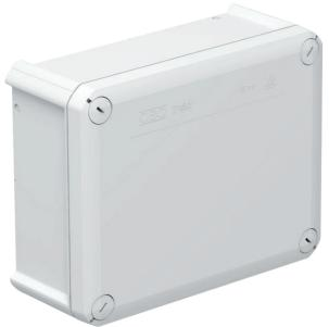
Scatola di derivazione per il collegamento di cavi e linee in ambienti interni ed ambienti esterni protetti. Forma rettangolare senza ingressi. Adatta per il montaggio su pareti e soffitti e il montaggio su lamiere di montaggio Con la possibilità di fissaggio interno e il montaggio su sezioni angolari. Coperchio con chiusura rapida, piombabile. Costruito con materiali privi di
