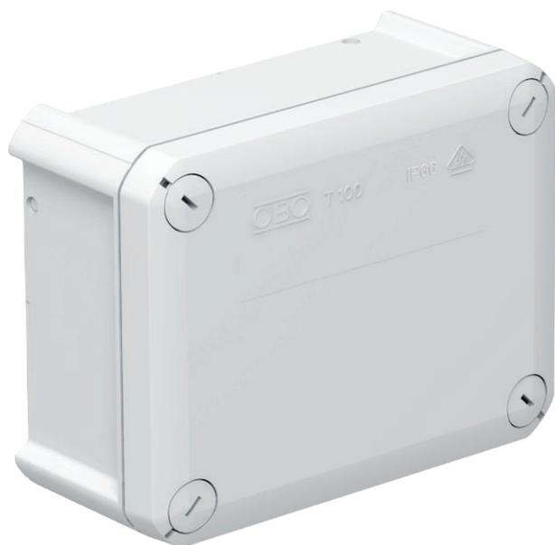
Scatola di derivazione per il collegamento di cavi e linee in ambienti interni ed ambienti esterni protetti. Forma rettangolare senza ingressi. Adatta per il montaggio su pareti e soffitti e il montaggio su lamiere di montaggio. Con la possibilità di fissaggio interno e il montaggio su sezioni angolari. Coperchio con chiusura rapida, piombabile. Costruito con materiali privi di alogeni.
