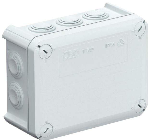
Scatola di derivazione per il collegamento di cavi e linee in ambienti interni ed ambienti esterni protetti. Forma rettangolare con tenute ad innesto sui lati e inserti di deviazione nel pavimento. Adatta per il montaggio su pareti e soffitti e il montaggio su lamiere di montaggio. Con la possibilità di fissaggio interno e il montaggio su sezioni angolari. Coperchio con chiusura rapida, piombabile. Costruito con materiali privi di alogeni.
