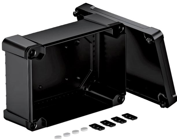
Scatola di derivazione per il collegamento di cavi e linee in ambienti interni ed ambienti esterni. Forma rettangolare senza ingressi. Adatta per il montaggio su pareti e soffitti con la possibilità di fissaggio esterno ed interno o il montaggio su sezioni angolari. Particolarmente resistente agli urti con IK08. Coperchio con chiusura rapida, piombabile. Costruito con materiali privi di alogeni e resistenti agli UV.
