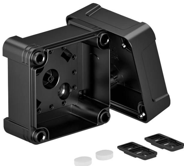
Scatola di derivazione per il collegamento di cavi e linee in ambienti interni ed ambienti esterni. Forma quadrata senza ingressi. Adatta per il montaggio su pareti e soffitti con la possibilità di fissaggio esterno ed interno o il montaggio su sezioni angolari. Particolarmente resistente agli urti con IK08. Coperchio con chiusura rapida, piombabile. Costruito con materiali privi di alogeni e resistenti agli UV.
