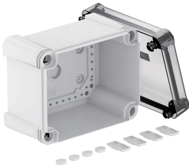
Scatola di derivazione per il collegamento di cavi e linee in ambienti interni ed ambienti esterni. Forma rettangolare senza ingressi. Adatta per il montaggio su pareti e soffitti con la possibilità di fissaggio esterno ed interno o il montaggio su sezioni angolari. Particolarmente resistente agli urti con IK09. Coperchio trasparente con chiusura rapida, piombabile. Costruito con materiali privi di alogeni e resistenti agli UV.
