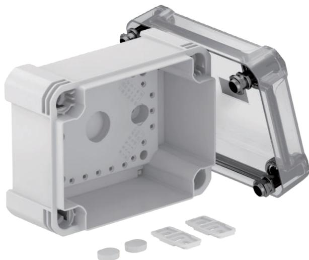
Scatola di derivazione per il collegamento di cavi e linee in ambienti interni ed ambienti esterni. Forma rettangolare senza ingressi. Adatta per il montaggio su pareti e soffitti con la possibilità di fissaggio esterno ed interno o il montaggio su sezioni angolari. Particolarmente resistente agli urti con IK08. Coperchio trasparente con chiusura rapida, piombabile. Costruito con materiali privi di alogeni e resistenti agli UV.
