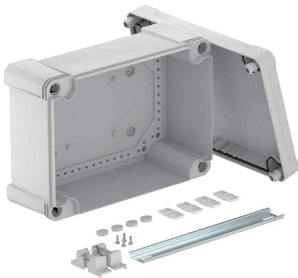
Scatola di derivazione con profilato di sospensione per il collegamento di cavi e linee in ambienti interni ed ambienti esterni. Forma rettangolare senza ingressi. Adatta per il montaggio su pareti e soffitti con la possibilità di fissaggio esterno ed interno o il montaggio su sezioni angolari. Particolarmente resistente agli urti con IK08. Coperchio con chiusura rapida, piombabile. Costruito con materiali privi di alogeni e resistenti agli UV.
