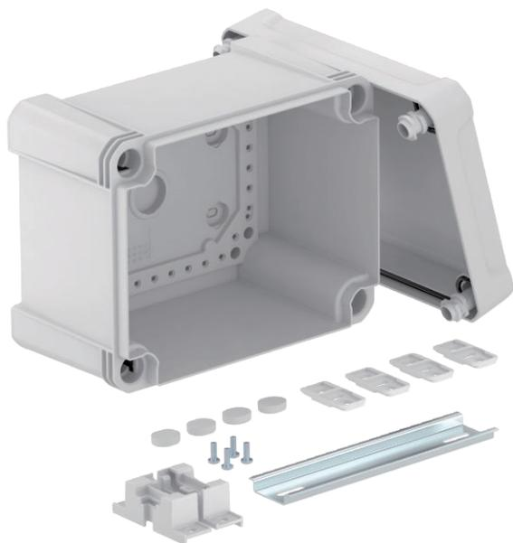
Scatola di derivazione con profilato di sospensione per il collegamento di cavi e linee in ambienti interni ed ambienti esterni. Forma rettangolare senza ingressi. Adatta per il montaggio su pareti e soffitti con la possibilità di fissaggio esterno ed interno o il montaggio su sezioni angolari. Particolarmente resistente agli urti con IK09. Coperchio con chiusura rapida, piombabile. Costruito con materiali privi di alogeni e resistenti agli UV.
