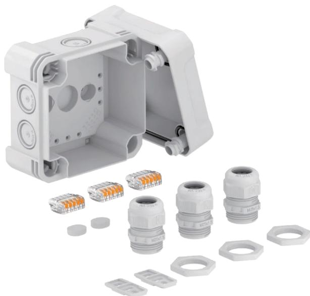
Scatola di derivazione con morsetto per il collegamento di cavi e linee in ambienti interni ed ambienti esterni. Forma quadrata con inserti di deviazione. Adatta per il montaggio su pareti e soffitti con la possibilità di fissaggio esterno ed interno o il montaggio su sezioni angolari. Particolarmente resistente agli urti con IK09. Coperchio con chiusura rapida, piombabile. Costruito con materiali privi di alogeni e resistenti agli UV.
