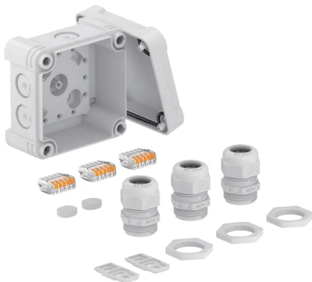
Scatola di derivazione con morsetto per il collegamento di cavi e linee in ambienti interni ed ambienti esterni. Forma quadrata con inserti di deviazione. Adatta per il montaggio su pareti e soffitti con la possibilità di fissaggio esterno ed interno o il montaggio su sezioni angolari. Particolarmente resistente agli urti con IK09. Coperchio con chiusura rapida, piombabile. Costruito con materiali privi di alogeni e resistenti agli UV.
