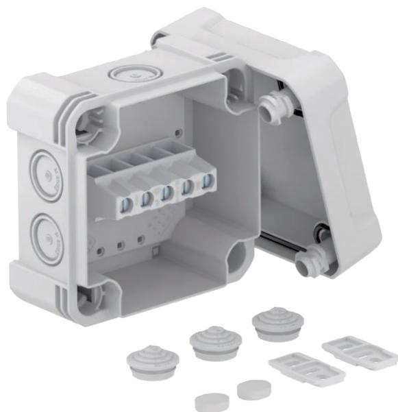
Scatola di derivazione con morsettiere per il collegamento di cavi e linee in ambienti interni ed ambienti esterni. Forma quadrata con inserti di deviazione. Adatta per il montaggio su pareti e soffitti con la possibilità di fissaggio esterno ed interno o il montaggio su sezioni angolari. Particolarmente resistente agli urti con IK09. Coperchio con chiusura rapida, piombabile. Costruito con materiali privi di alogeni e resistenti agli UV.
